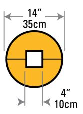
El protector de columna Column Sentry® CS1442-4S está diseñado para adaptarse a columnas cuadradas, redondas o en H de hasta 4 "x4" (100x100 mm) de tamaño. Con un diámetro exterior de 14 "(356 mm), el Column Sentry® Small es ideal para entrepisos, transportadores u otras áreas pequeñas. Pesa 24 libras (11 kg).
