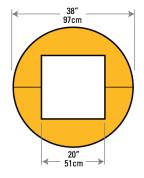
El protector de columna Column Sentry® CS3842-20S está diseñado para adaptarse a columnas en H, cuadradas o redondas de hasta 20 "x 20" (51x51 cm) de diámetro. El diámetro exterior es de 38 "(97 cm)
